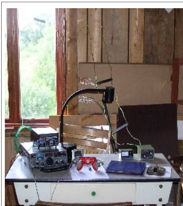
Sprzęt na strychu. Linia 600om prowadzi do anteny Doublet.
